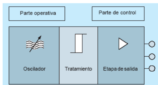
Composición de un detector de proximidad inductivo
