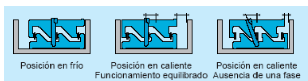
Principio de detección de pérdida de fase
